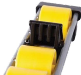
Le blocage de retour empêche les produits de repartir en arrière et est parfaitement adapté pour le chargement automatique des systèmes d'introduction.
